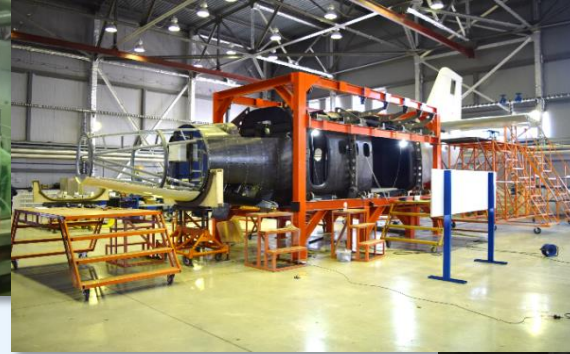
Фюзеляж ТВС-2ДТС на этапе ступельной сборки
