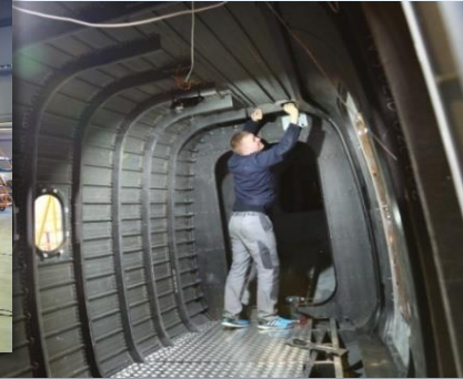
Фюзеляж ТВС-2ДТС на этапе ступельной сборки
