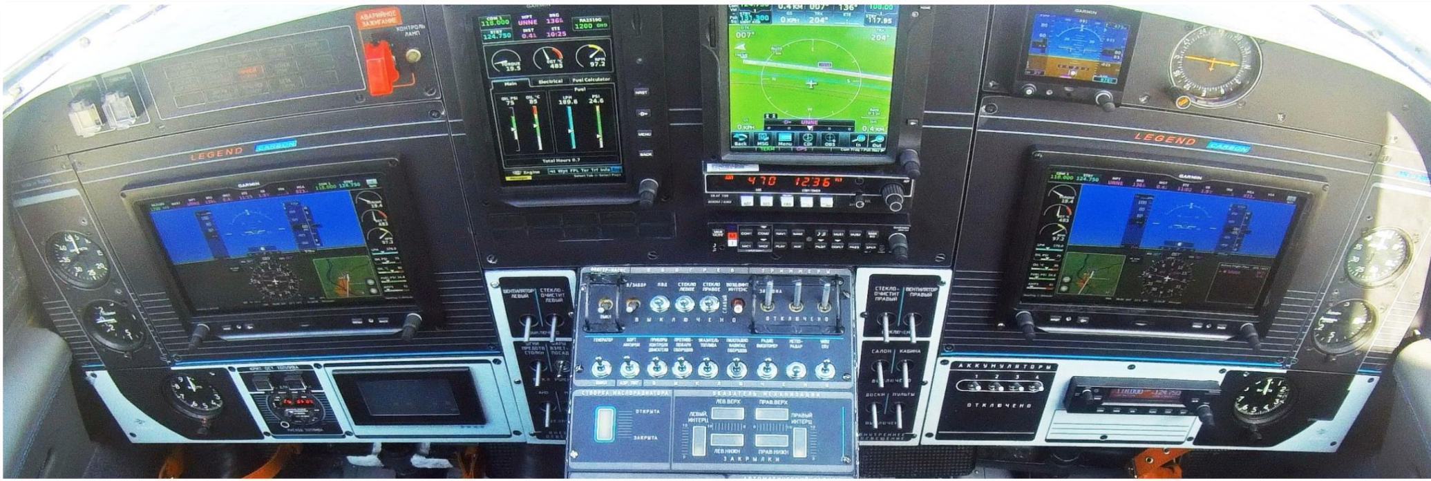
Многофункциональный комплекс пилотажно-навигационного оборудования с функцией синтетического видения «Garmin G3X Touch»
