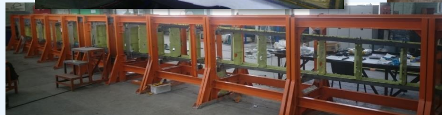
Верхнее крыло ТВС-2ДТС на этапе ступельной сборки
