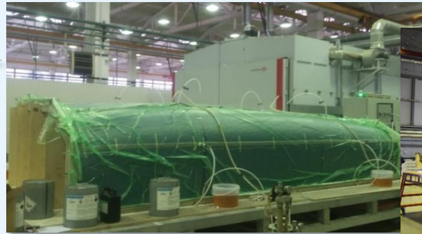
Изготовление панели фюзеляжа методом вакуумной инфузии
