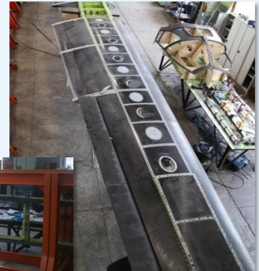
Верхнее крыло ТВС-2ДТС в сборе
