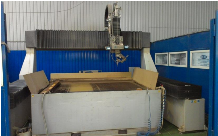
Установка 5-ти координатной гидроабразивной резки фирмы «FLOW»
