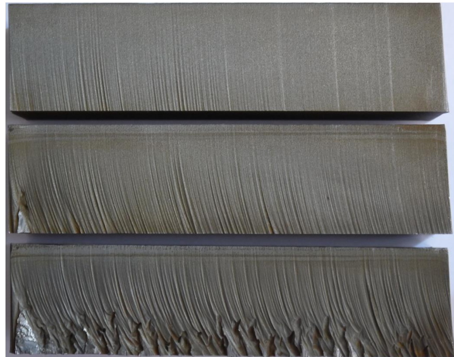
Образцы из закаленной стали 30ХГСА при изменении подачи от 5 до 120 мм/мин
