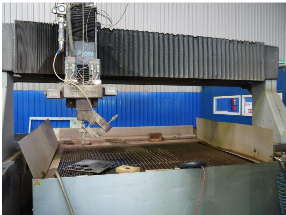
Установка гидроабразивной резки фирмы «Flow»
