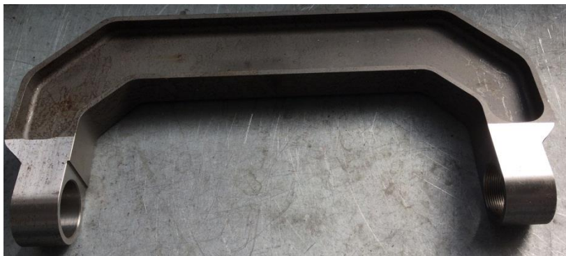
Деталь скоба после механической обработки на станках с ЧПУ
