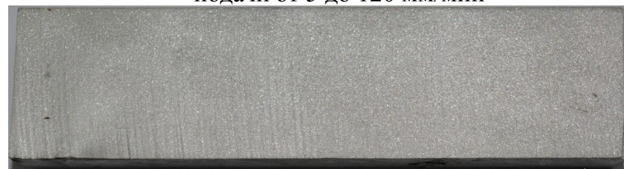
Образцы из алюминиевого сплава Д16Т при изменении подачи от 5 до 40 мм/мин от 85 до 125 мм/мин от 165 до 20 мм/мин
