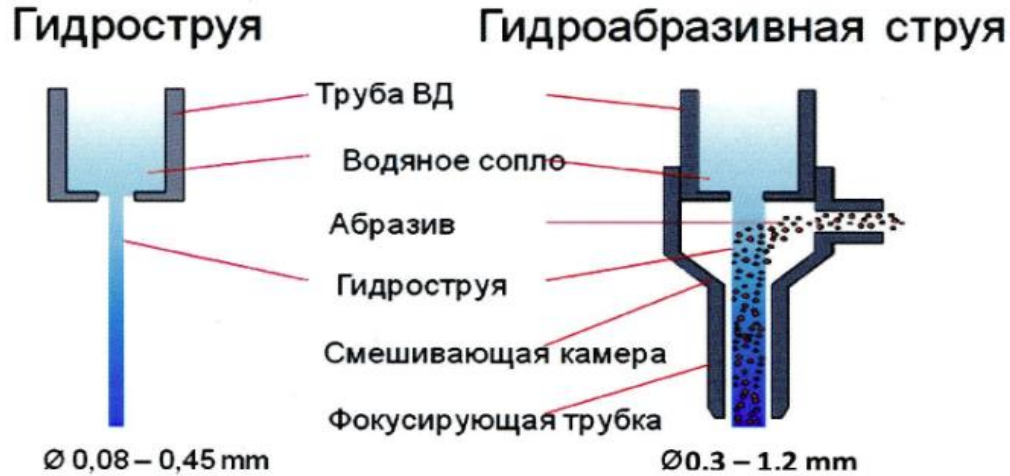
Схема образования гидроабразивной режущей струи
