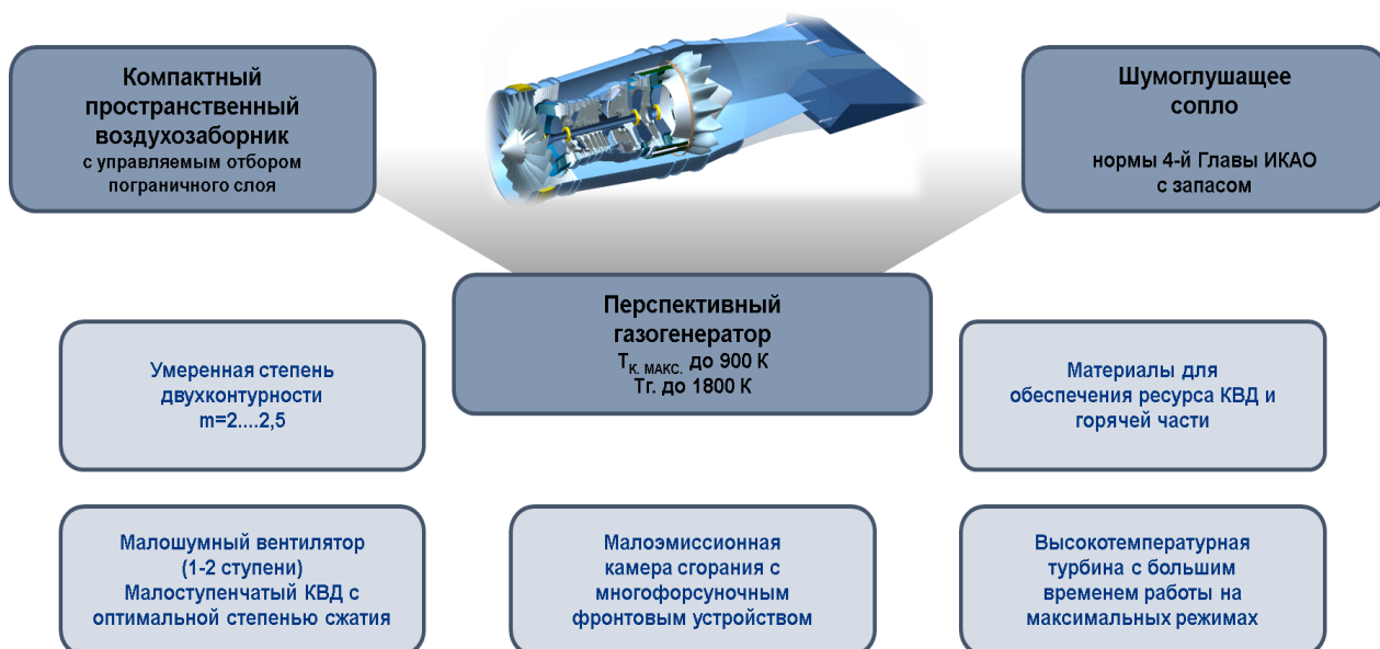
Рисунок 1.2.1 - Технический облик перспективной СУ СГС
