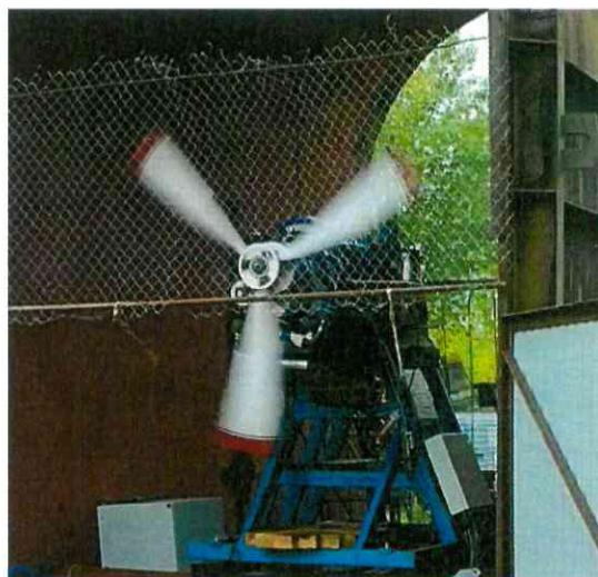
Рис.1 Двигатель АПД-А на испытательном стенде Ц-22АПД
