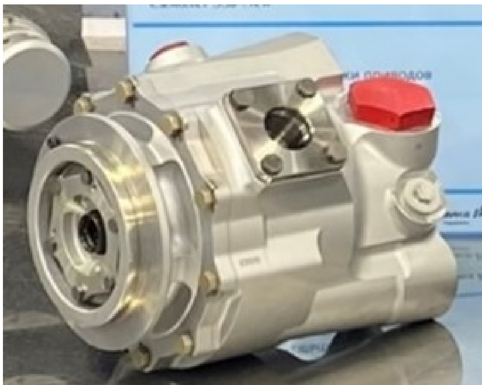
Рисунок 6.1.1. Трехмерная модель Гидронасоса HP152
