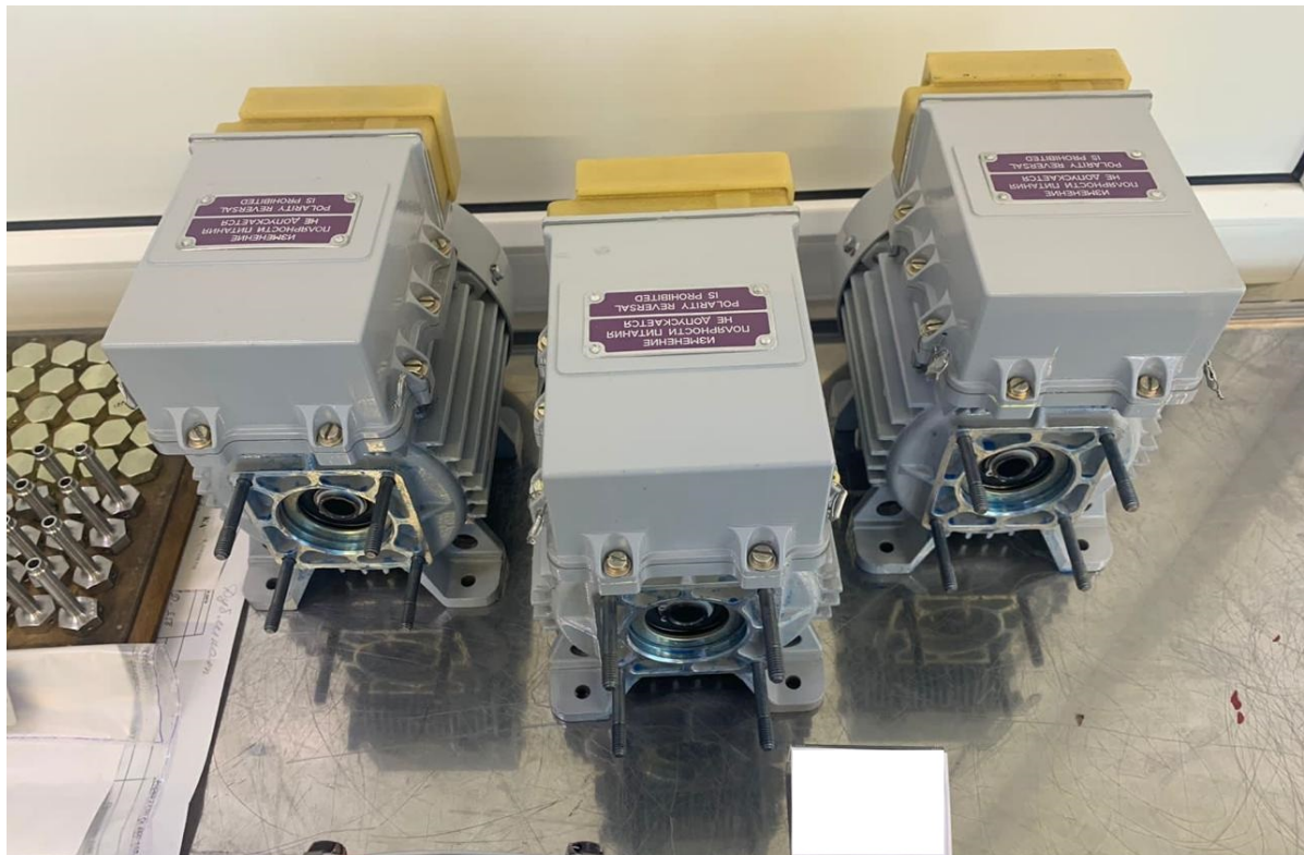
Рисунок 6.9.1 Электродвигатель Насосной станции постоянного тока
