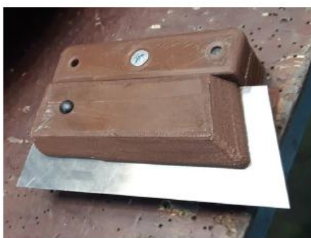
Рисунок 2. Образец формблока № 2 из материала ABS
