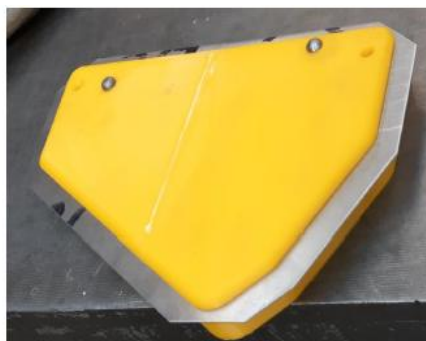
Рисунок 1 Образец формблока № 1 из материала ABS
