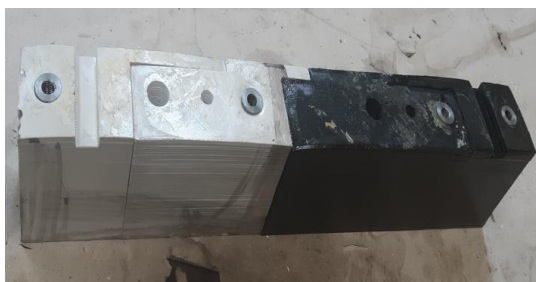
Рисунок 3 Образец прижима из материала ABS
