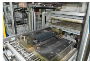
Термоформование в прессе ПАО «ОДК-Сатурн»
