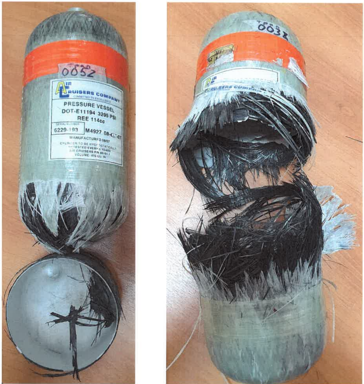
Рис. 3. Баллоны после испытаний на разрушение
