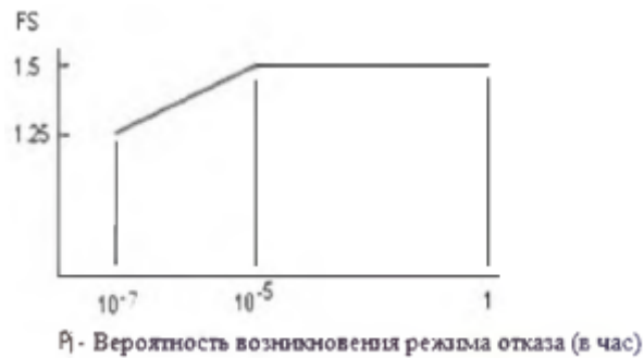
Рисунок С1 Коэффициент безопасности режима отказа (в час)
