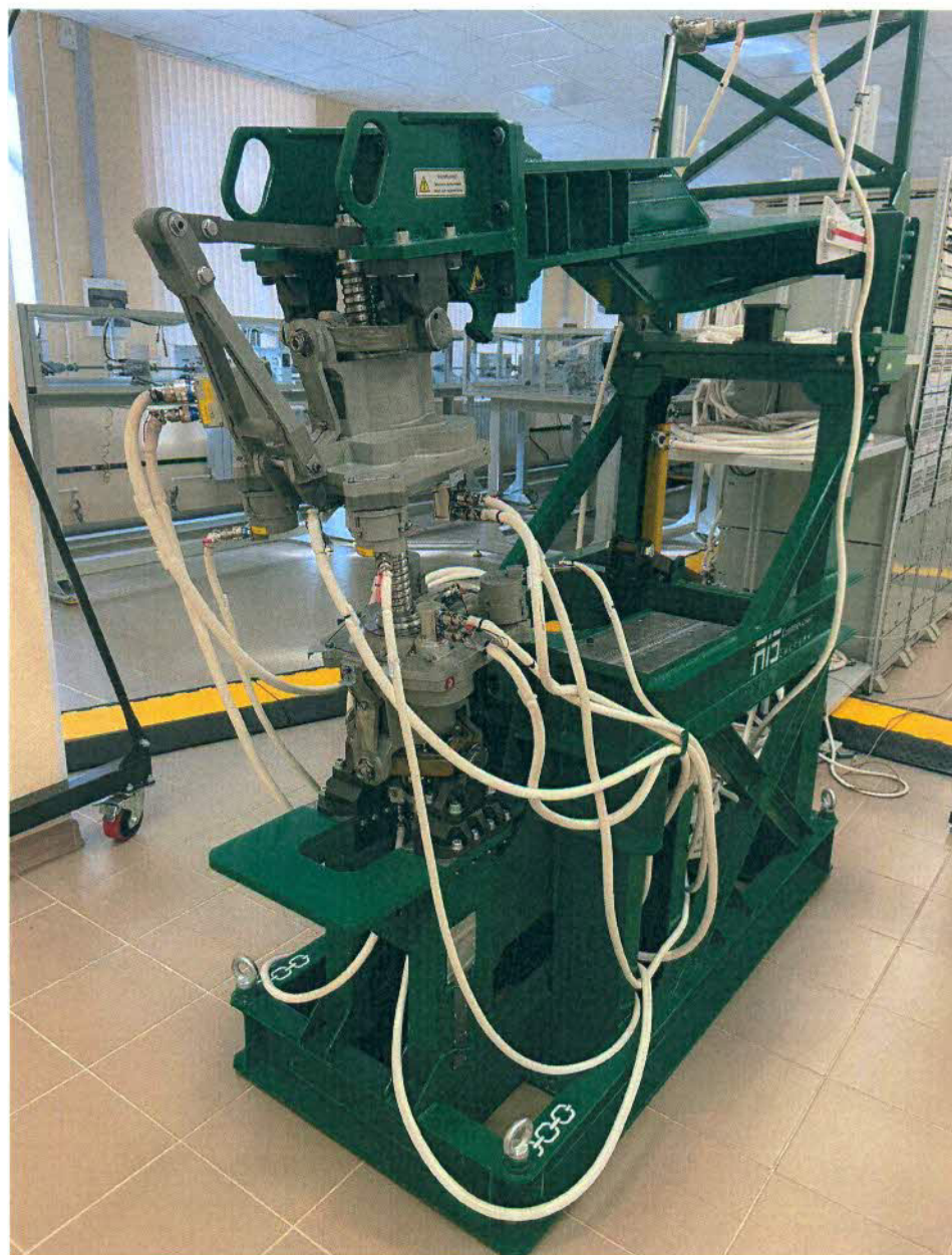
Рисунки 1-3. Интеграционный стенд KCU SSJ-NEW
