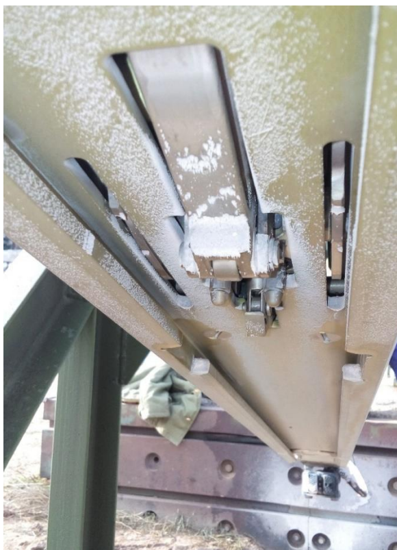
Рисунок 41 – Воздействие конденсированной фазы реактивной струи на элементы УАПУ
