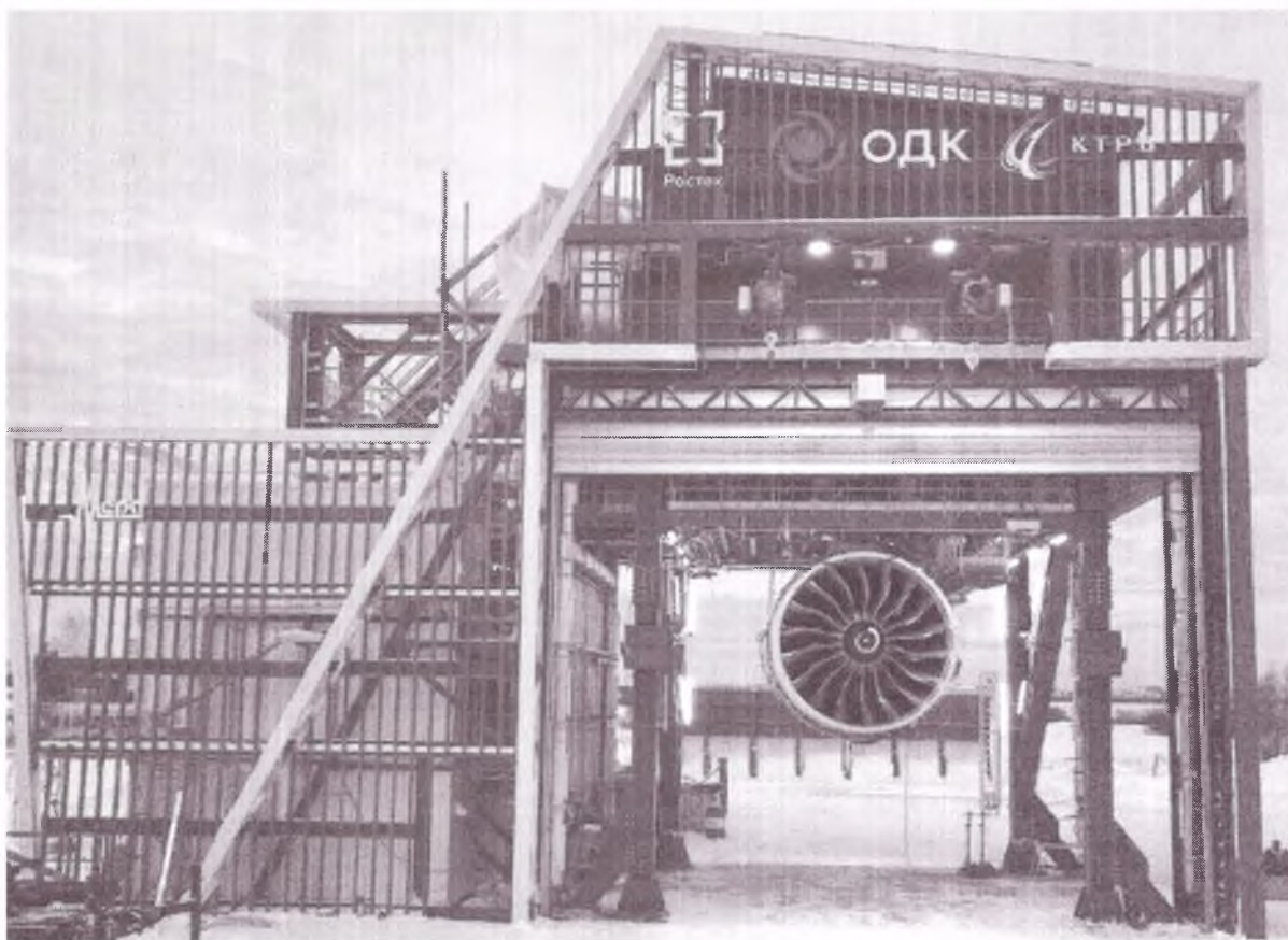
Рисунок 4 – Открытый стенд ДДТ ПД-35
