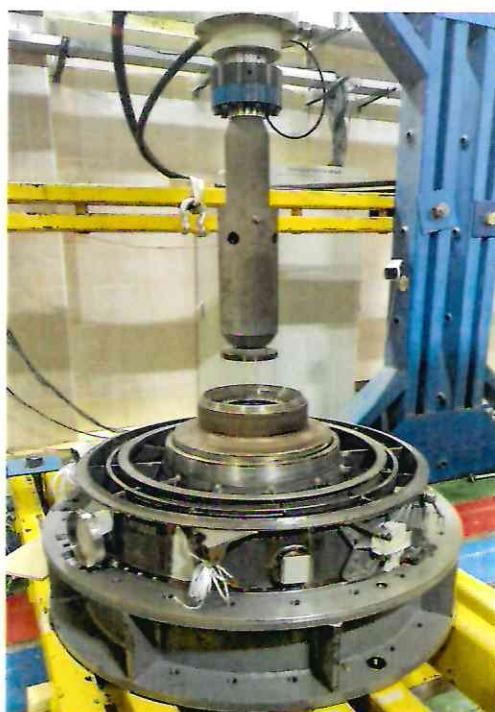
По результатам тарировки датчиков в лабораторных условиях получают тарировочные графики для заведения их в измерительную аппаратуру при испытании ГТД.
