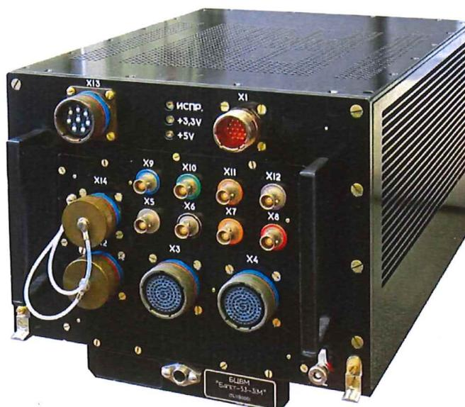
**Рисунок 1. Фотография БЦВМ «Багет-53-31М»**
