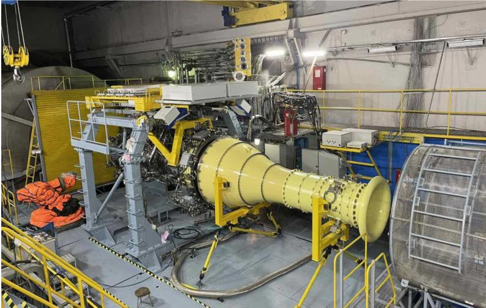
Рисунок А.1 – Демонстрационный газогенератор ПД-35 на стенде №1 АО «ОДК-Авиадвигатель»
