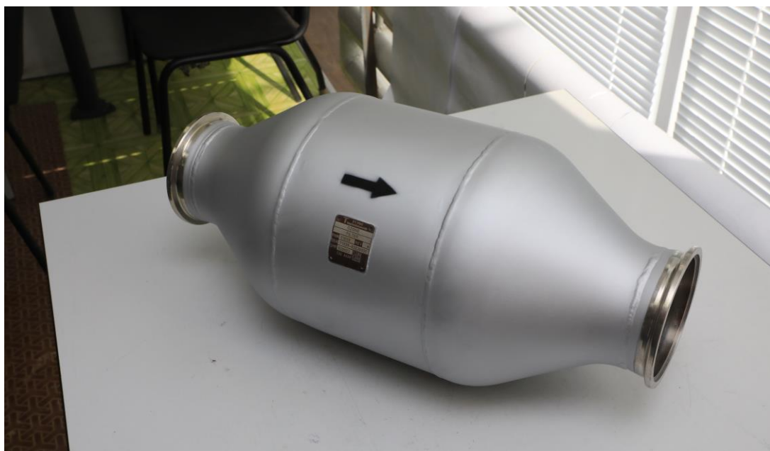
Рисунок 4 - Фотография опытного образца озонового фильтра производства АО ПКО «Теплообменник» после испытаний
