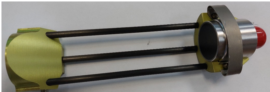
Рисунок 5 – Оснастка с коническим зеркалом, закрепленная на преобразователе
