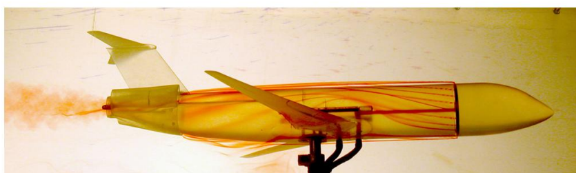
Рисунок 14. Визуализация течения относительно компоновки пассажирского самолета в гидротрубе
