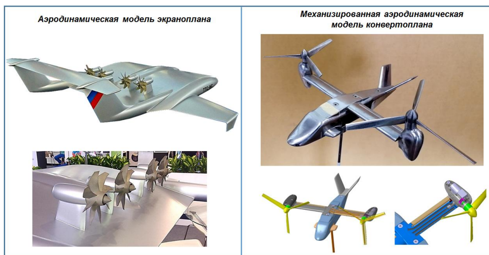
Рисунок 27. Аэродинамические модели полностью изготовленные с применением аддитивных технологий
