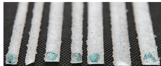
б) Имитаторы обледенения на кромках крыла
