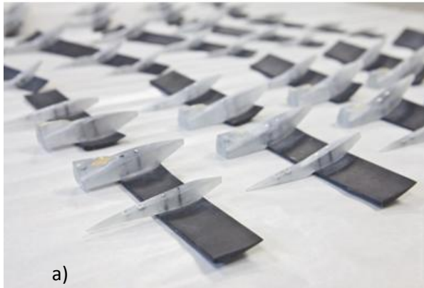
Рисунок 6. Обтекатели кронштейнов крепления механизации крыла
