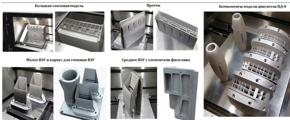
Рисунок 25. Особо сложные компоненты аэродинамических моделей
