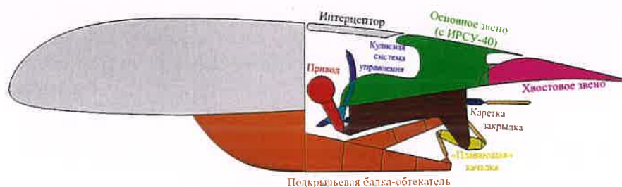
Рисунок 19 – Крейсерское (убранное) положение закрылка
