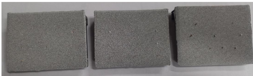
Рисунок 1 (продолжение) – Внешний вид напыленных секторов 1-й и 2-й ступени ТВД
