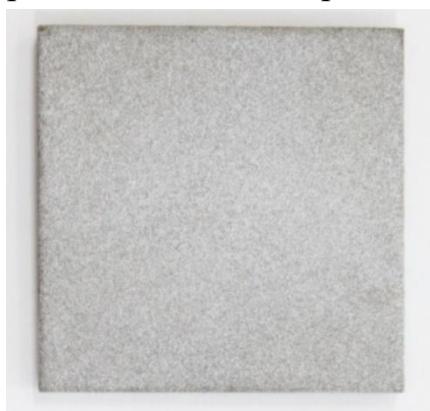
Рисунок 1 – Внешний вид напылённого покрытия на образце-свидетеле.
