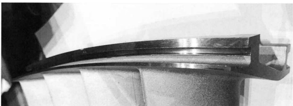
Рис. 2 - Внешний вид обработанной поверхности канавки с применением специального эльборового шлифовального круга
