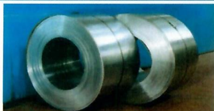
Обшивочные листы толщиной 1,2 мм из сплава 1163РДТВ
