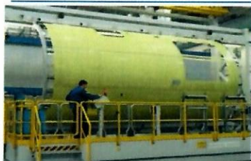
Листы из сплава 1163 в конструкции фюзеляжа самолета МС-21
