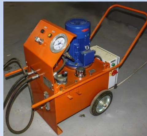
Гидростанция СГ-С-6-290-30-4-ИГП P_{\max} = 300 Бар.
