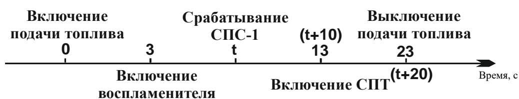
Рисунок 3 – Последовательность событий огневого пуска
