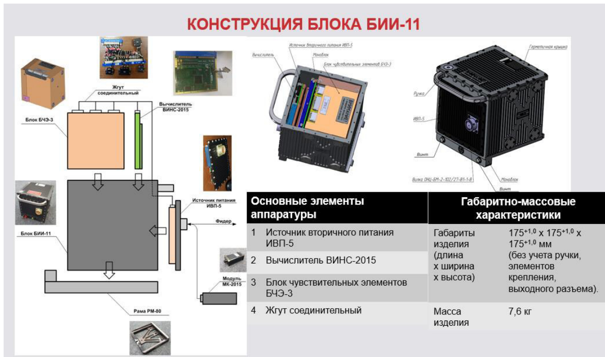
Рисунок 3. Состав блока БИИ-11
