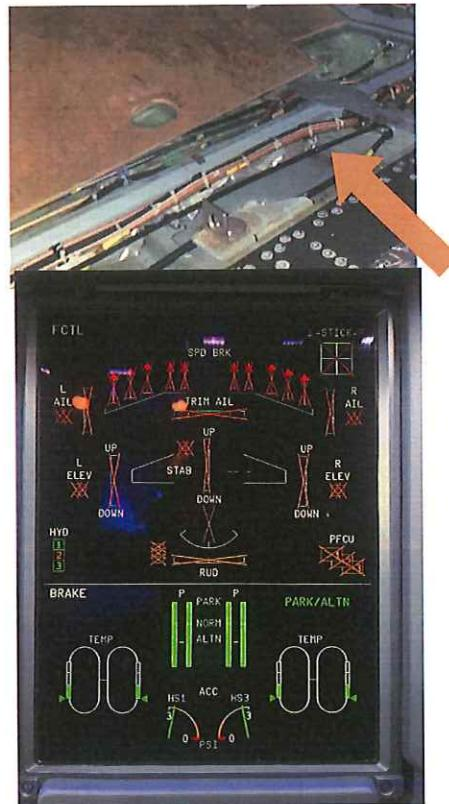
Рисунок 7 – Трос стояночного тормоза самолета SSJ-NEW в ходе проверки на самолете SSJ-95
