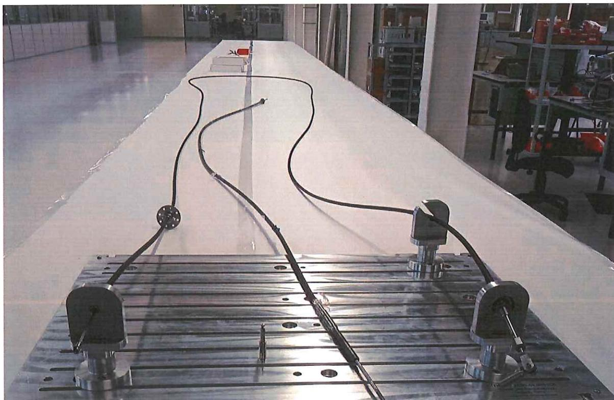
Рисунок 9 – Сборочный участок тросов (оснастка для сборки не показана) со стендом для проведения ПСИ тросов и образцами изделий
