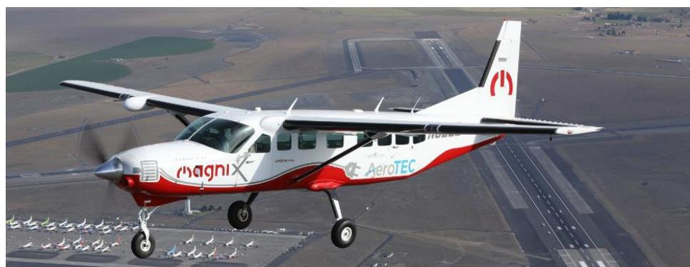
Рисунок 2. Полностью электрический самолет Cessna ECaravan с оборудованием MagniX.
