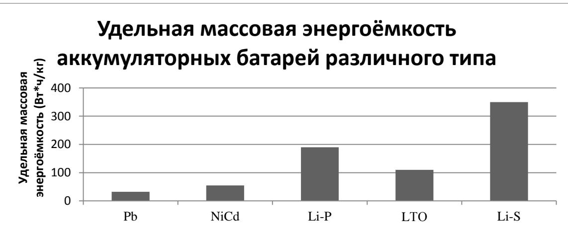
Рис 9. Графическое сравнение удельных массовых энергоёмкостей аккумуляторных батарей различного типа.
