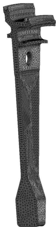
Рисунок 43 – Сетка конечных элементов и нагрузки модели диска лабиринта
