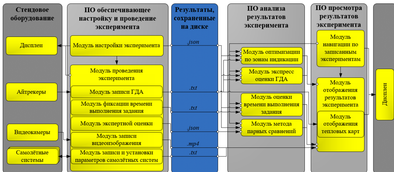
Рисунок 13. Программная архитектура ПАК эргономических оценок ИУП кабины пилотов
