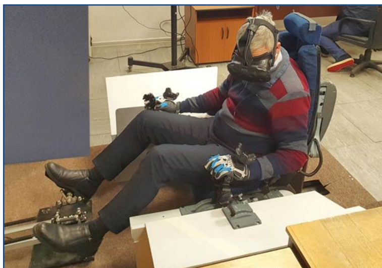
Рисунок 7. Комплекс виртуального моделирования кабины ВС (VR)
