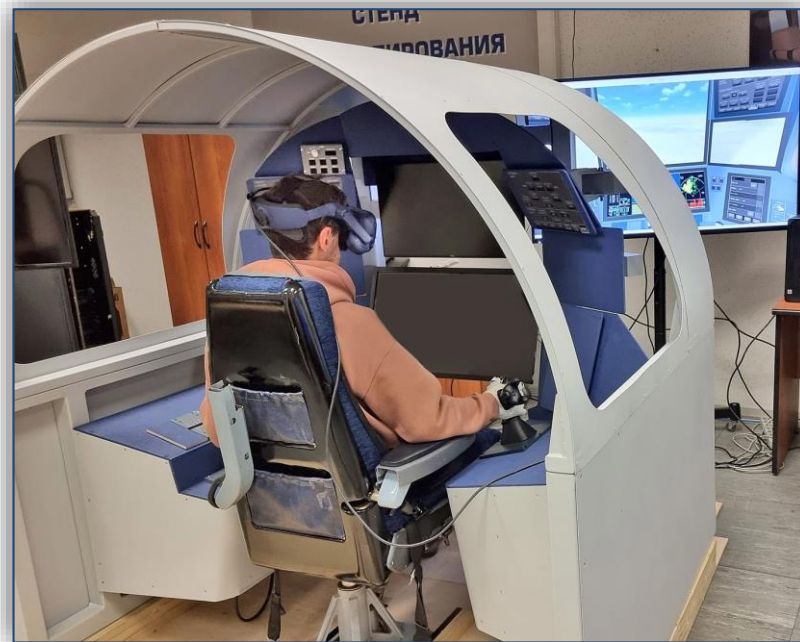
Рисунок 8. Комплекс виртуального моделирования кабины ВС (с макетом кабины)
