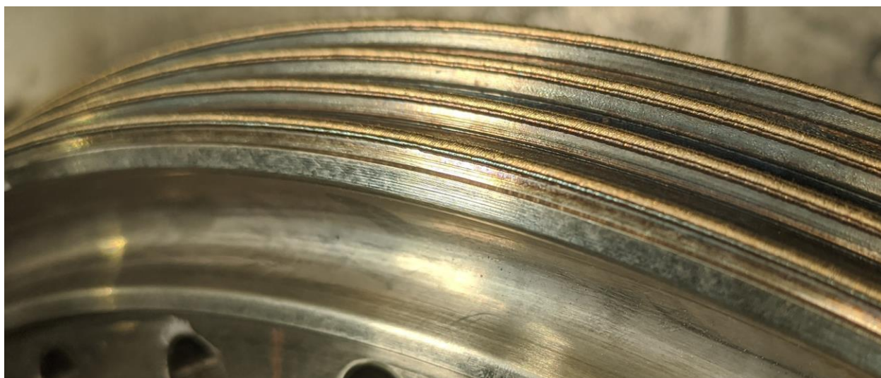
Рисунок 1 – Внешний вид ребешков диска турбины после наплавки
