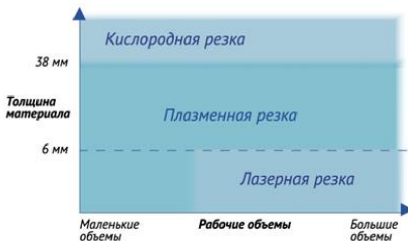
Рисунок 1 – График оптимального способа резки металла
