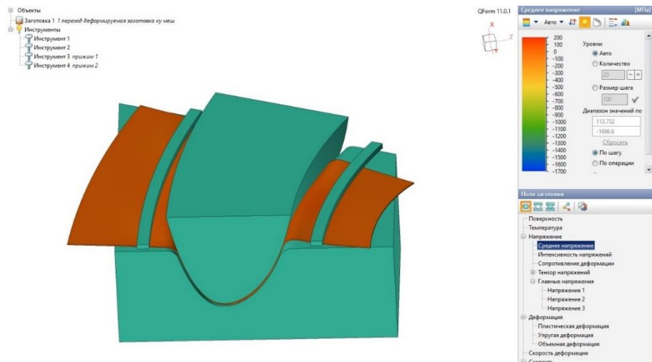
Рисунок 11 – Среднее напряжение при изготовлении детали на втором переходе.
