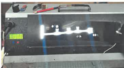
Рисунок 8 – Рентгеноконтроль сварных швов
