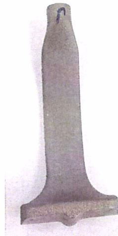
Рисунок 3 – Фасонированная заготовка под изотермическую штамповку из синтезированной титановой МПК методом СЭЛС.
