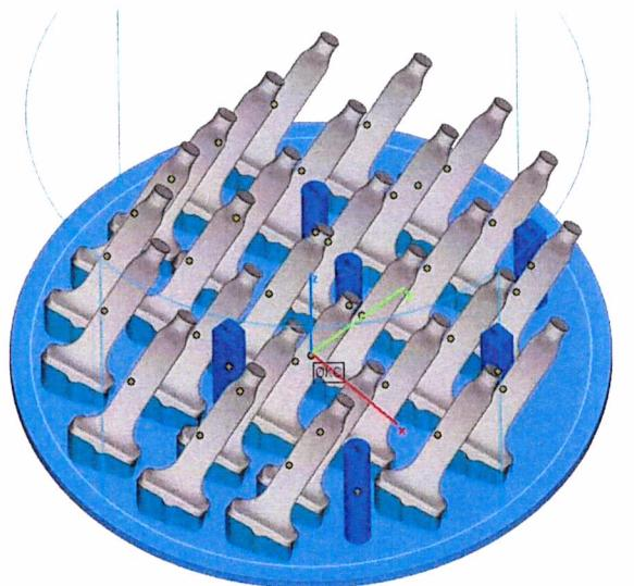
Рисунок 2 – Расположение заготовок на платформе
