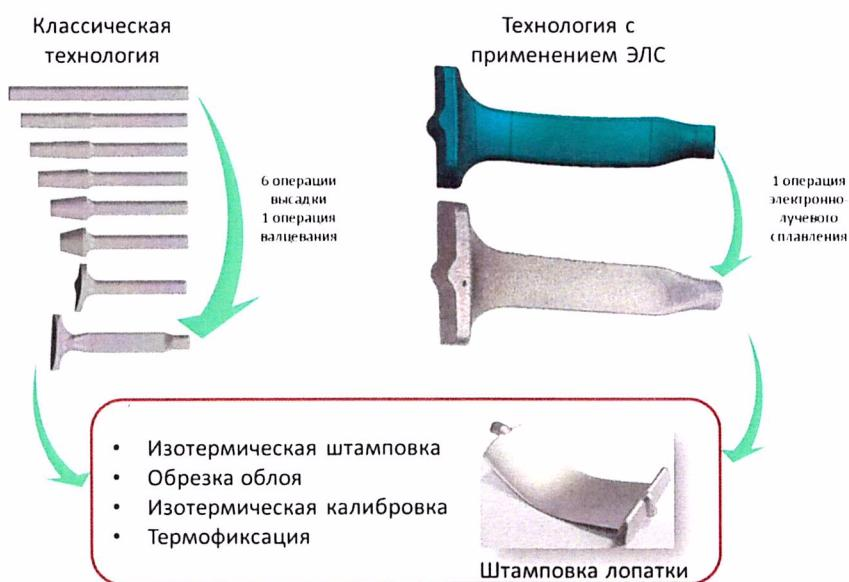
Рисунок 1 – Процесс получения фасонированной заготовки
