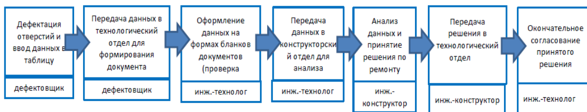
Рис. 4. Блок-схема процесса работы с данными дефектации разъема ОЧК с ЦЕ
