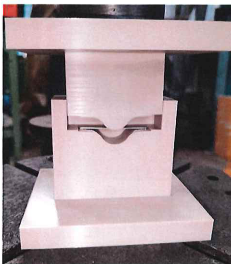
Рисунок 2. Штамповая оснастка на гидравлическом вытяжном прессе мод. НВС-2-16
