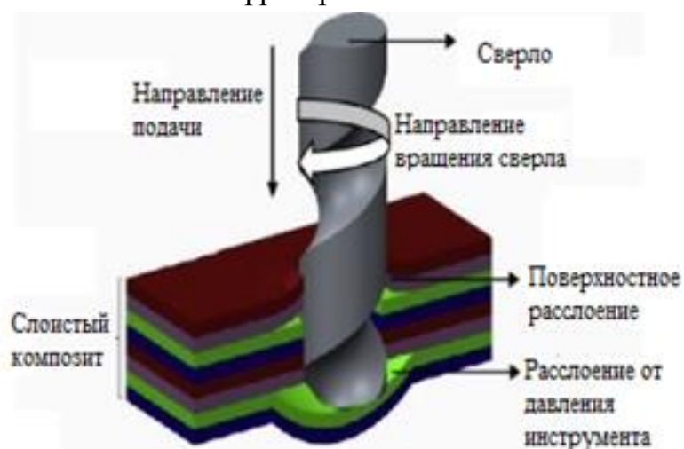
Рисунок 1.3 – Формирование внутренних повреждений в ПКМ при фрезеровании
