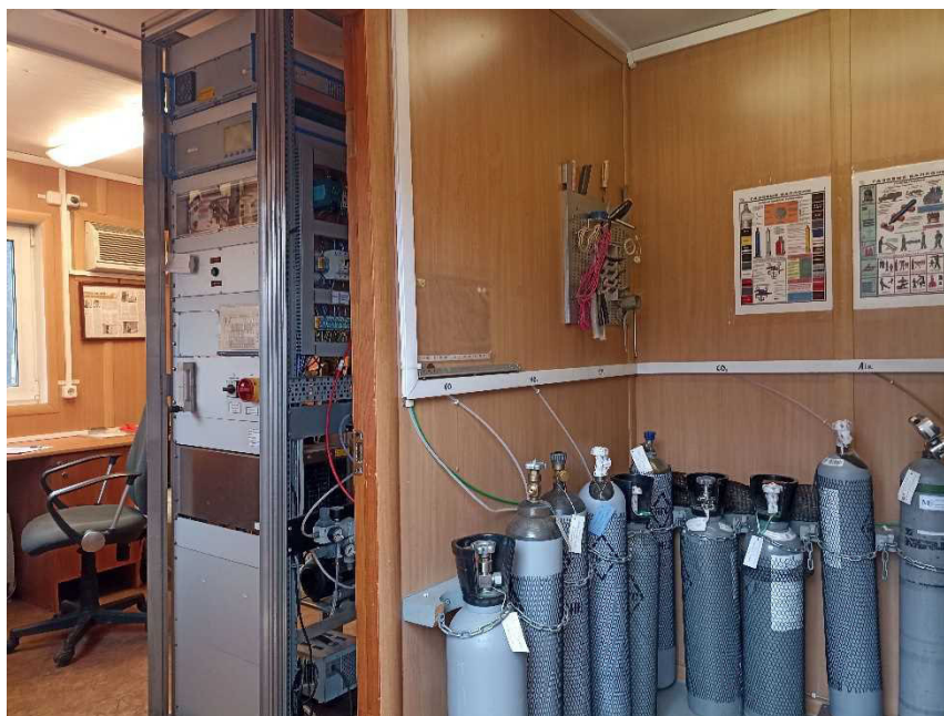
Рисунок 13 – Оборудование для замера эмиссии газообразных вредных веществ, уровня дымления и эмиссии нелетучих твердых частиц
