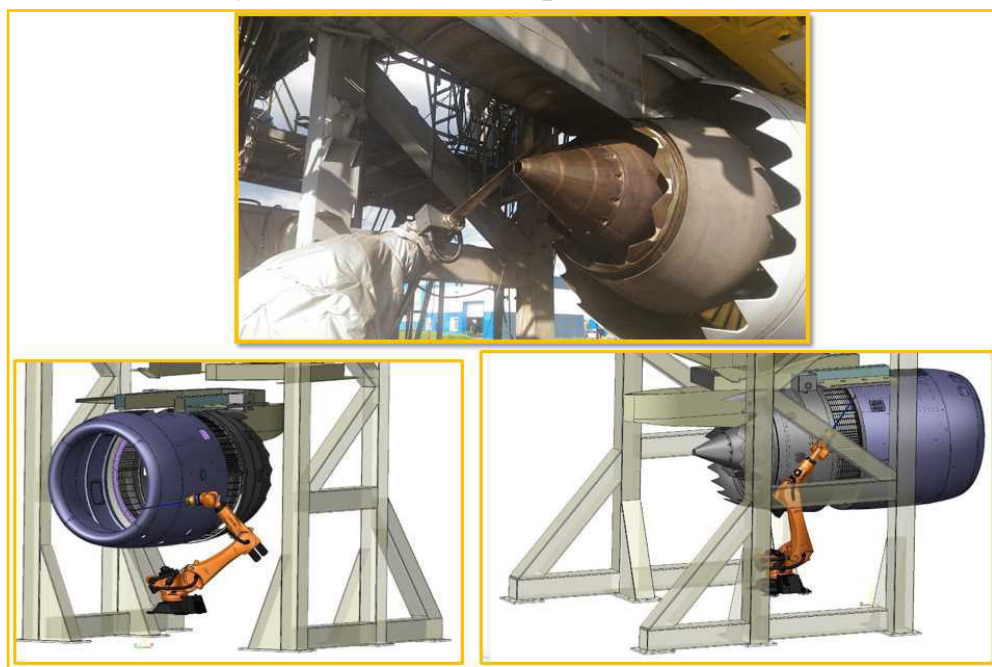
Рисунок 14 – Измерительный элемент системы измерения скоса потока, установленный на фланце ПР
