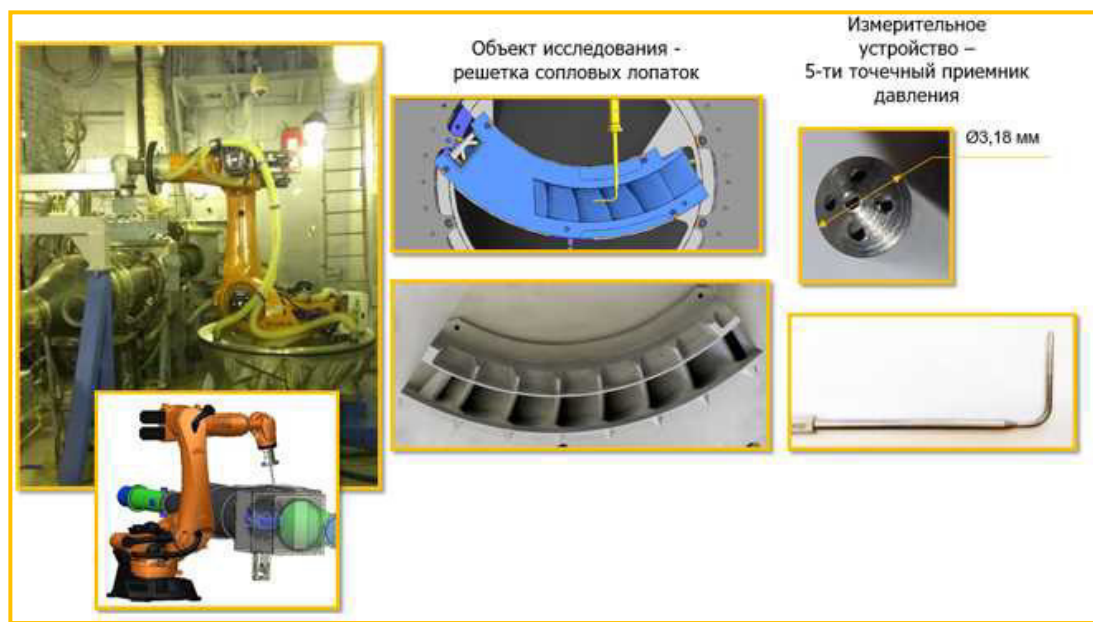
Рисунок 16 – Аэродинамическое исследование лопаток турбин с использованием разработанного РТК
