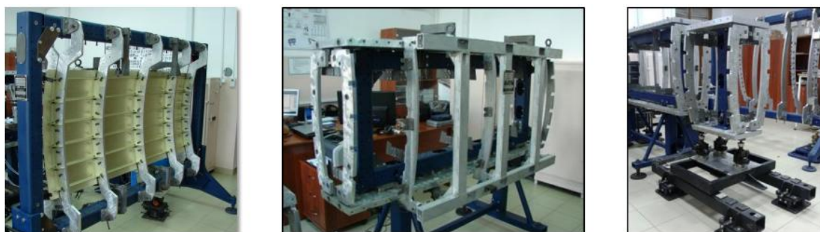
Лабораторные стелды для узловой и агрегатной сборки и стыковки изделий авиационной техники
