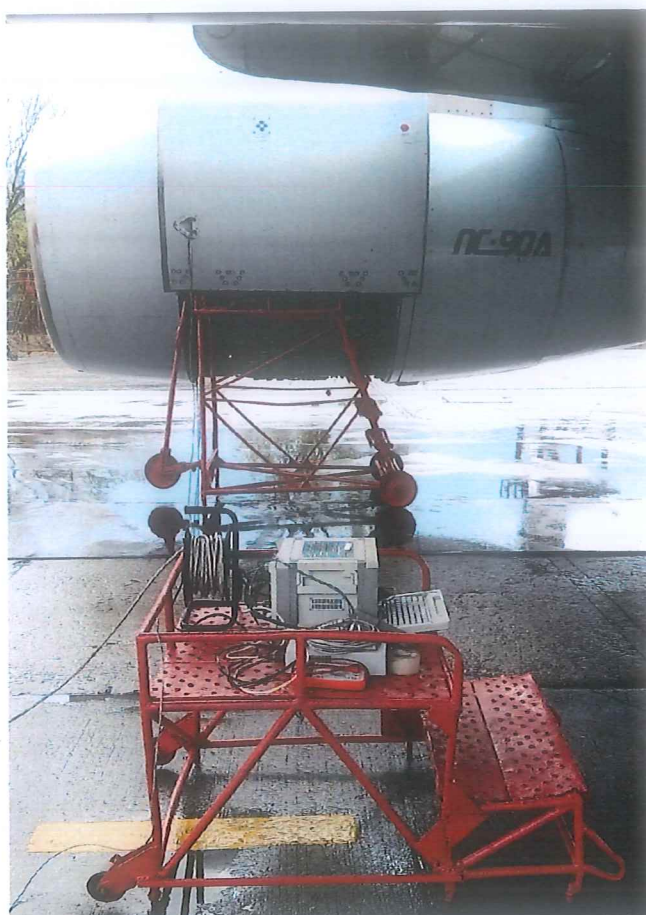
Рисунок 6 – Контроль в эксплуатации вынужденных колебаний, характеризующих уровни возбуждения переменных напряжений в зубчатых колесах ЦП
