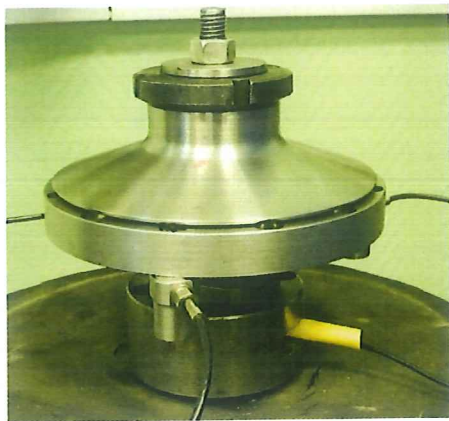
Рисунок 10 – Вибростенд для испытания конических колёс с демпфером сухого трения
