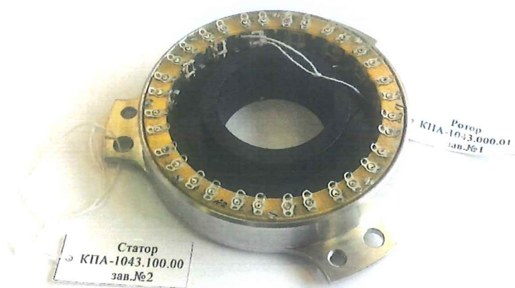
Рисунок 13 – Встраиваемый магнитоэлектрический датчик для контроля кинематической погрешности ЦП на рабочих режимах
