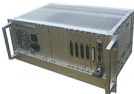
Рисунок 14 – Стендовый блок для контроля вынужденных колебаний и кинематической погрешности, характеризующих уровни возбуждения переменных напряжений в зубчатых колесах ЦП и УП
