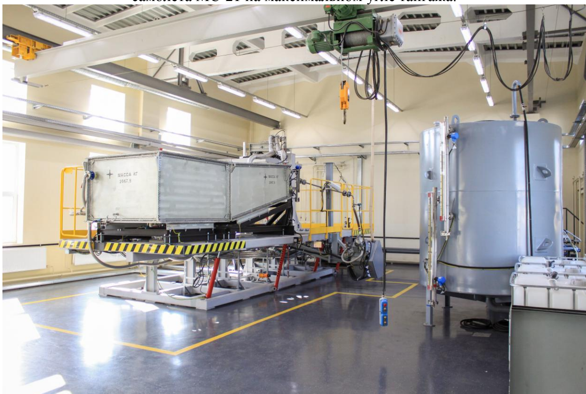
Положение объекта испытания при отработке технологии испытаний топливной системы самолета МС-21 на угле тангажа равном нулю.
