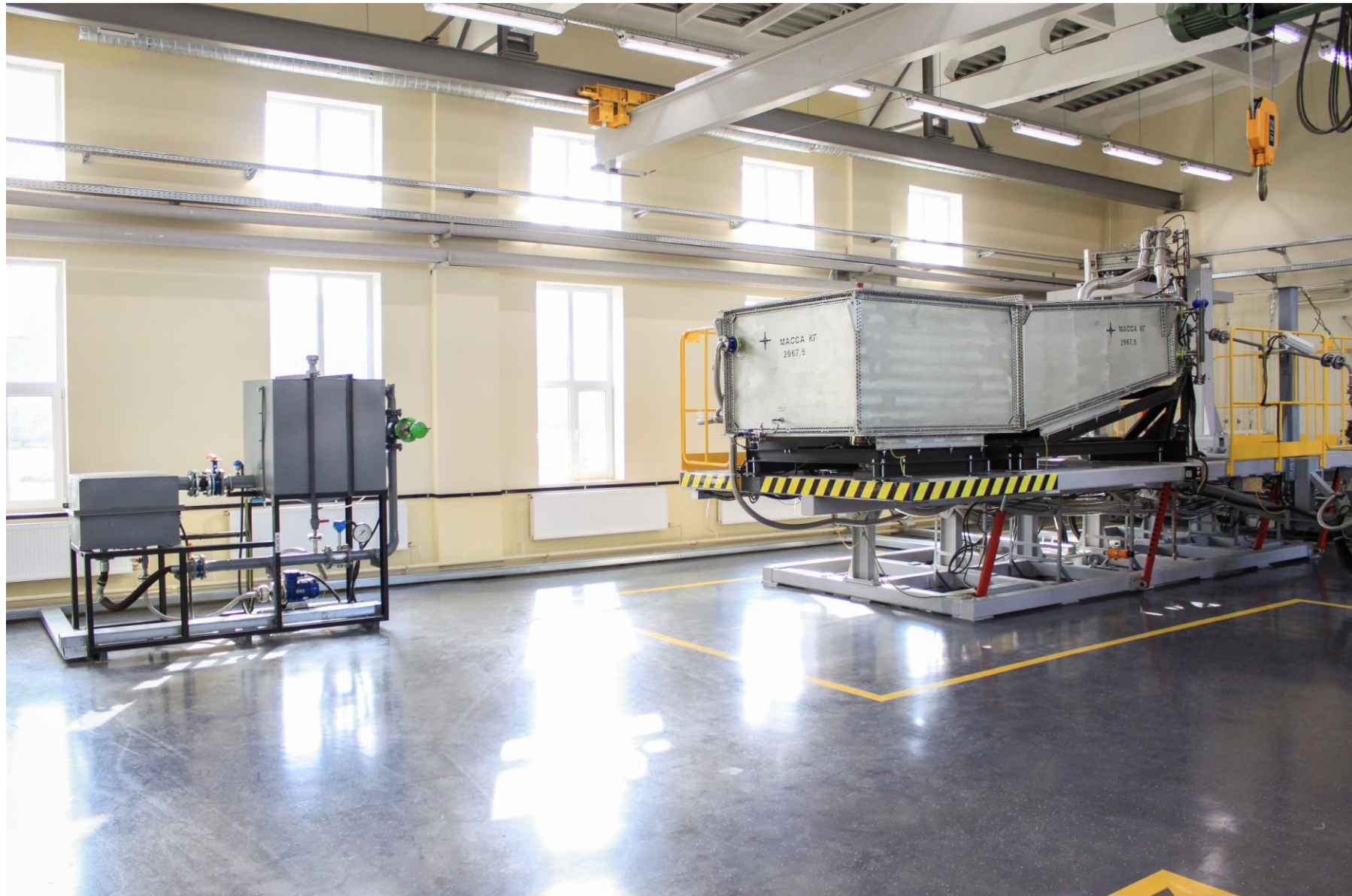
Испытательный комплекс топливных систем и их компонентов. Стендовый зал. Справа – стенд топливной системы СТ21-1, слева – стенд силовой автоматики ССА.
