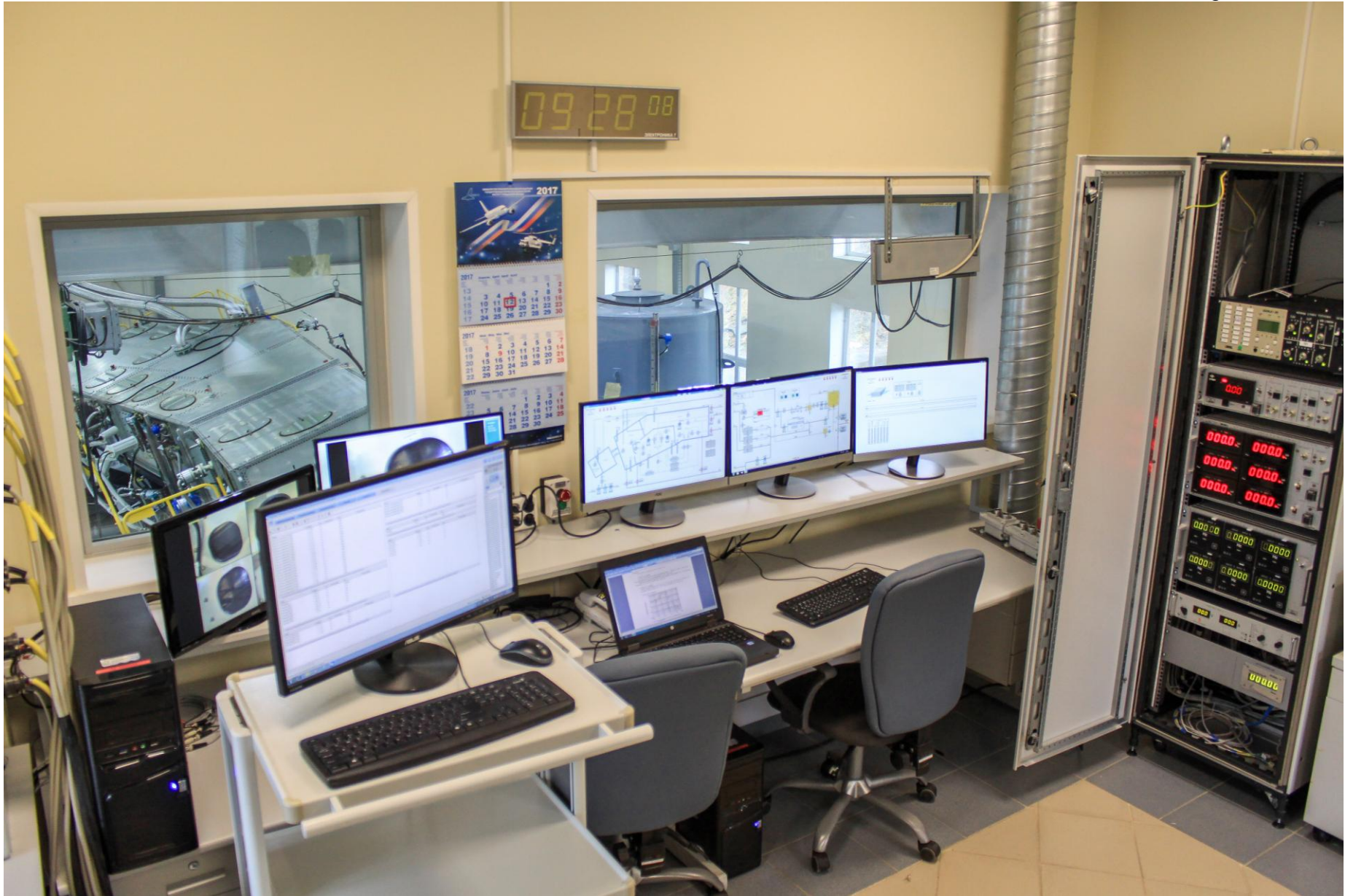
Стенд топливной системы СТ21-1. Помещение пультной. В окне слева – объект испытаний, полунатурная модель топливной системы самолета МС-21.
