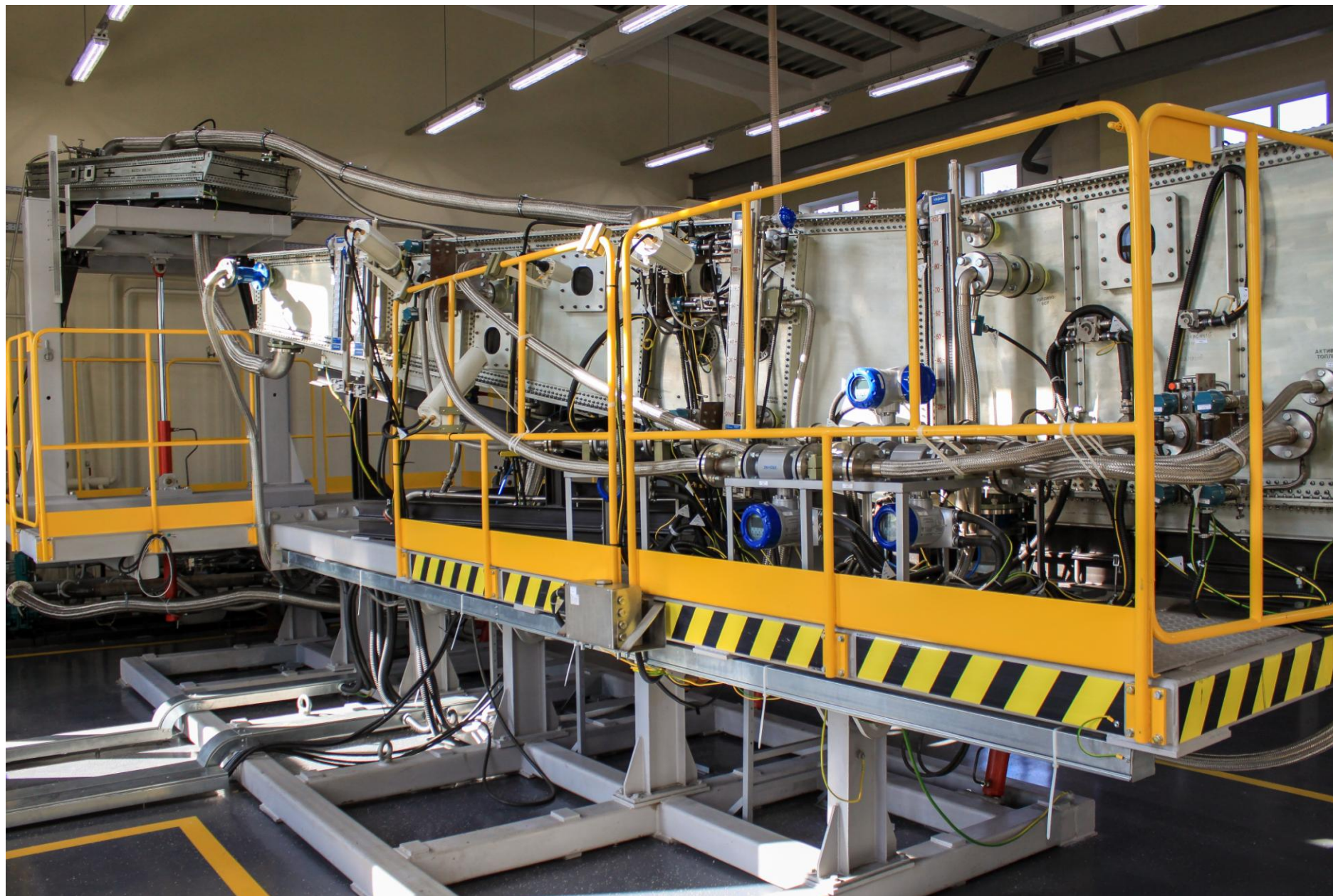
Стенд топливной системы СТ21-1. Основной и дополнительный стендовые баки объекта испытаний.
