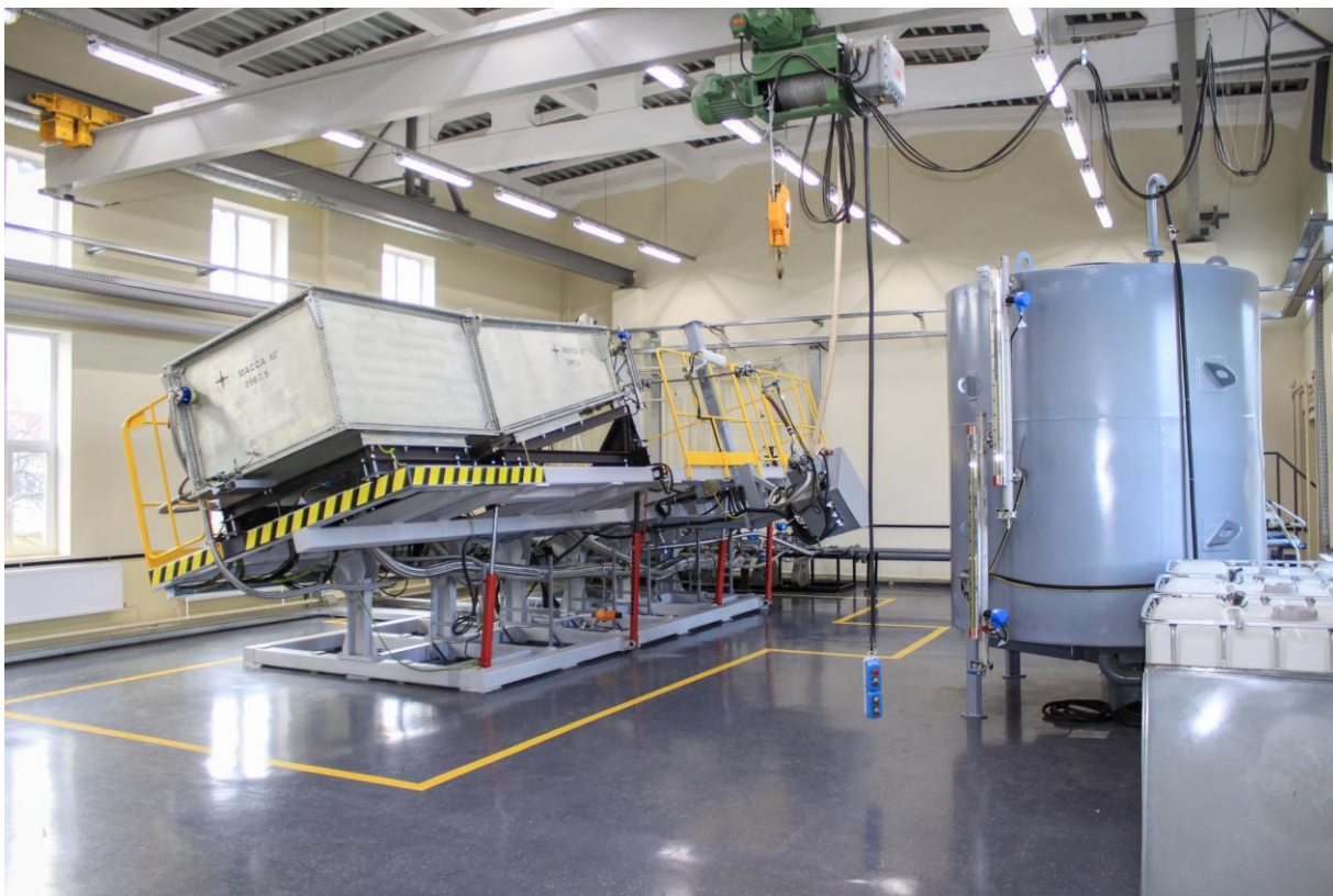
Положение объекта испытания при отработке технологии испытаний топливной системы самолета МС-21 на максимальном угле тангажа.
