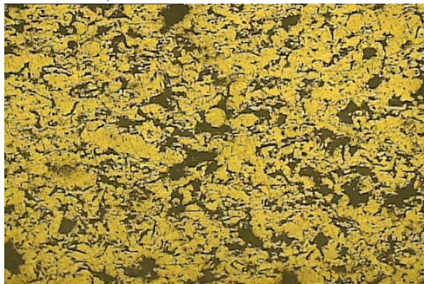
Рисунок 3 - Структура срабатываемого покрытия, напыленного из порошкового материала
