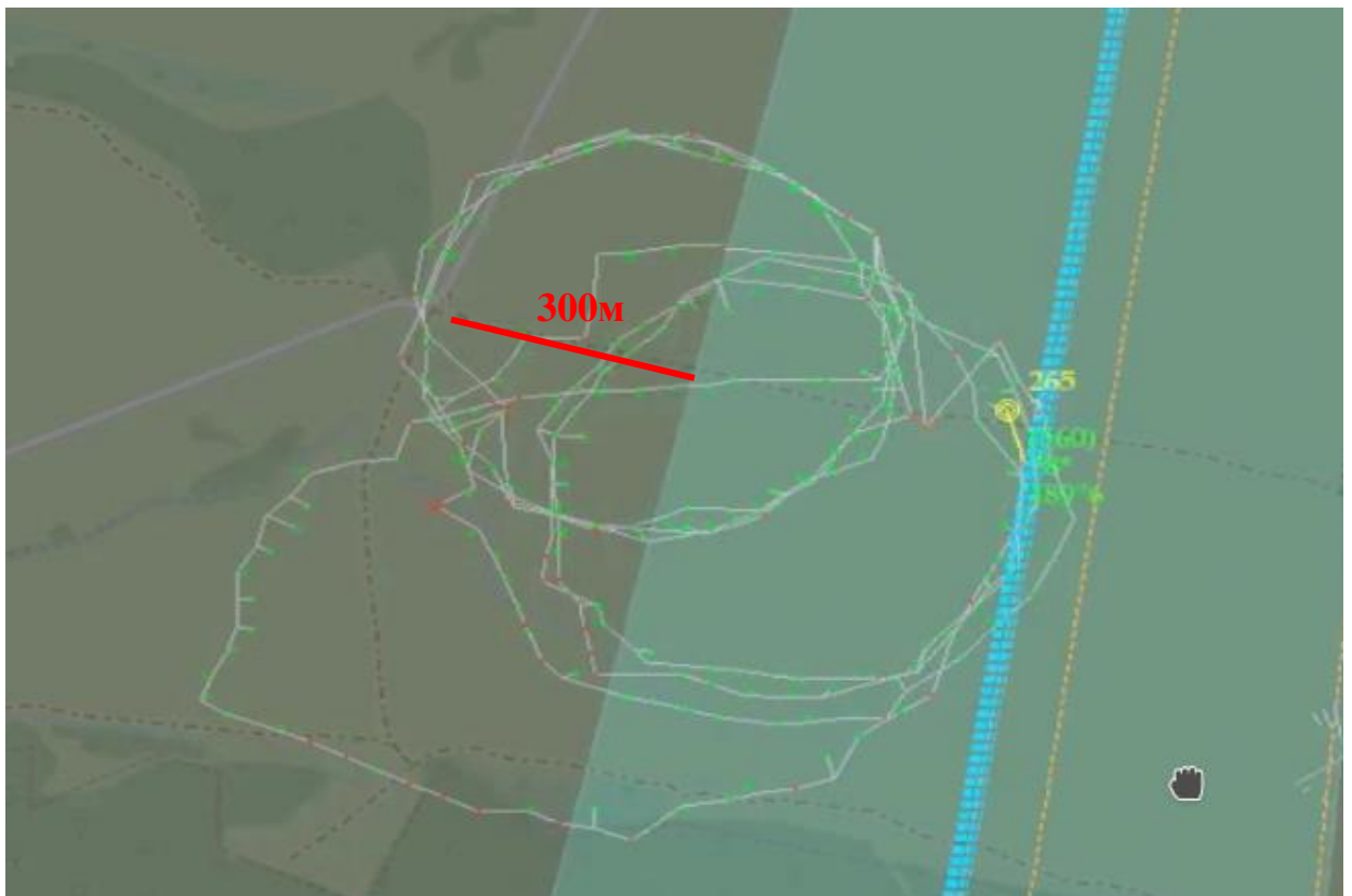
Рисунок 6 – Обнаружение и сопровождение БЛА SuperCam (6км) различными каналами комплекса (РЛС, ОЭС, РТР)
