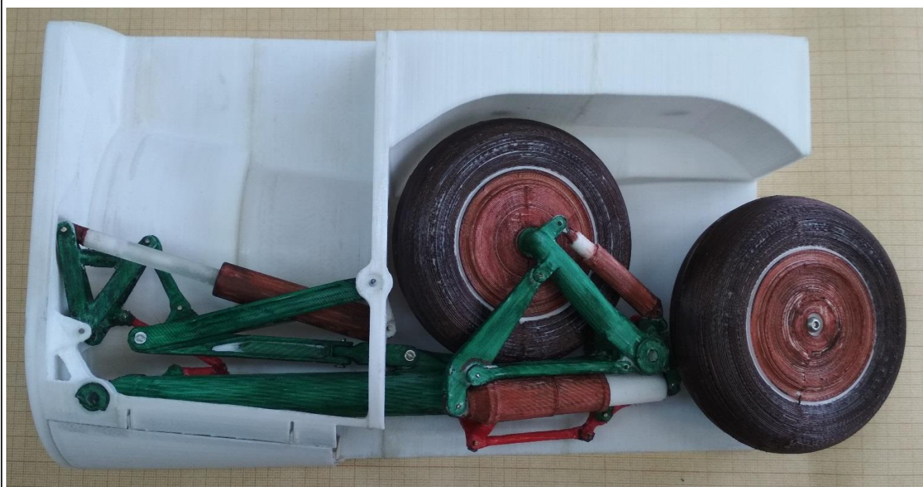
Рисунок 13 – Макет правой основной опоры шасси в убранном положении
