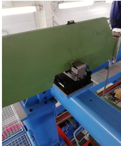
Рисунок 22 – механизм Z с уровнем
