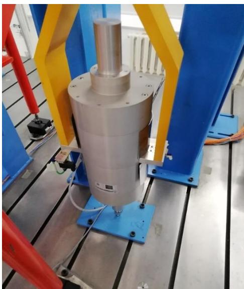
Рисунок 9 – демонтаж силовозбудителя
