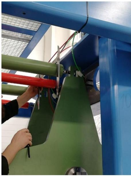
Рисунок 37 – измерение соосности
