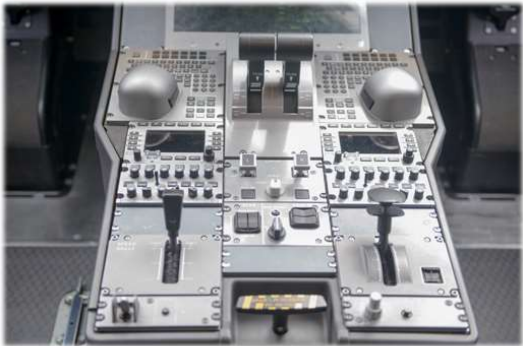
Рисунок 7 – Модульная конструкция со жгутовой обвязкой центрального пульта в кабине самолета МС-21
