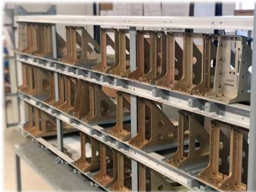
Рисунок 2 – Модель модульная конструкция со жгутовой обвязкой комплексного стеллажа бортового оборудования в багажно-грузовом отсеке самолета МС-21 в сборе
