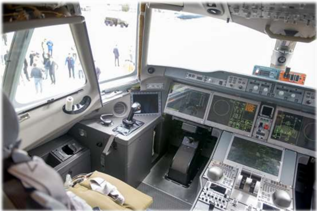
Рисунок 9 – Модульная конструкция со жгутовой обвязкой приборной доски в кабине самолета МС-21
